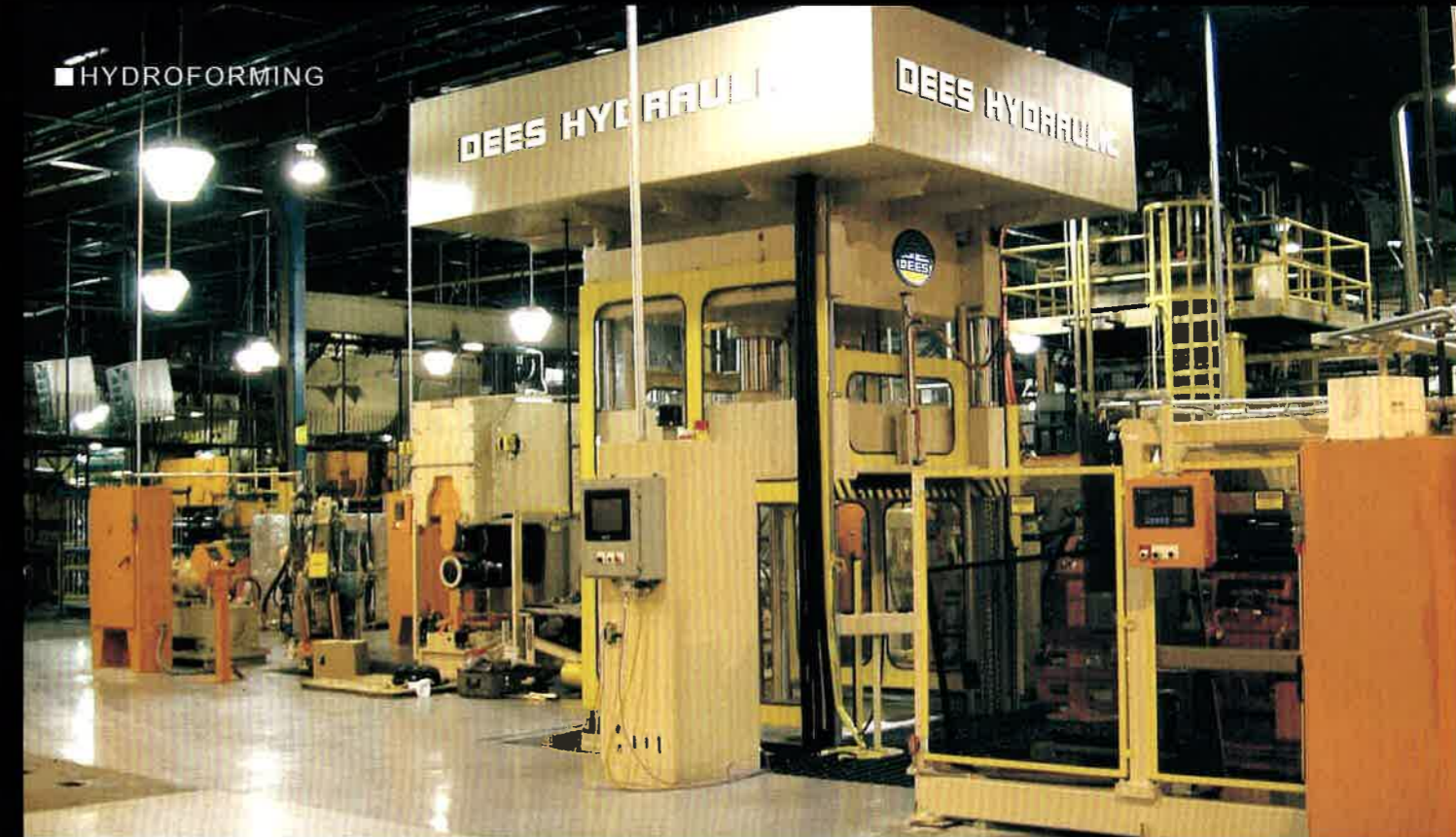
■ 300 TON 四柱型沖床配置美國 ALLEN-BRADLEY 觸摸式螢幕控制器, 可顯示機器全程工作狀態, 若需更高精密控制, 可搭配以下二者其一: — 速度比例閥 — 壓力比例閥
